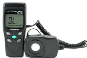
شكل 13: جهاز قياس الضوء TM-201L المستخدم في القياسات الميدانية
