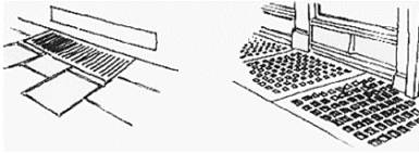
شكل (20): شبكات لصف مياه المطر ذات غطاء عبارة عن شبكة من الحديد الزهر ويراعي وضع هذه الشبكات أمام نوافذ البوروم إن وجد وذلك تحسبا لتسرب مياه المطر الي البوروم بسبب انخفاضه . المصدر [18]
