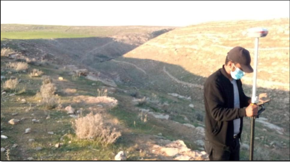
الشكل (7): العمل الميداني باستخدام تطبيق (Green Land)، وجهاز (RTK).
